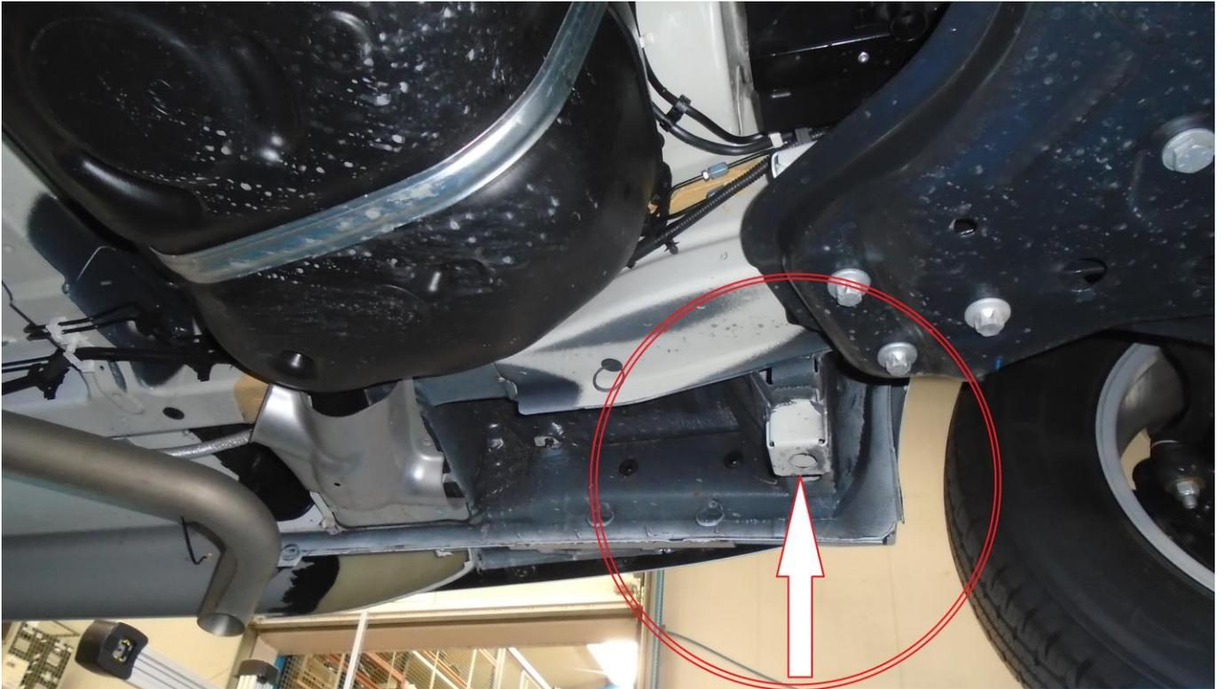
**ACHTUNG** Es muss gewährleistet sein, dass die Stütze ausgekurbelt werden kann.
